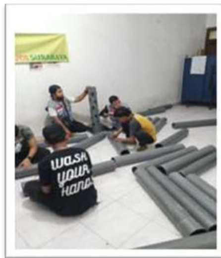
Gambar 3. Proses Pelubangan Pipa Paralon
