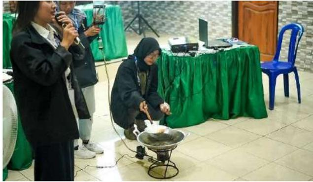
Gambar 10. Menggoreng Telur Menggunakan Kompor Bahan Bakar Minyak Jelantah dan Oli Bekas
