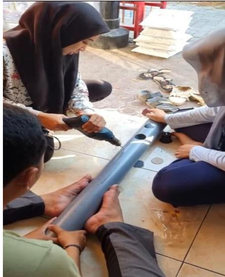
Gambar 2. Pembuatan Media Tanaman Hidroponik
